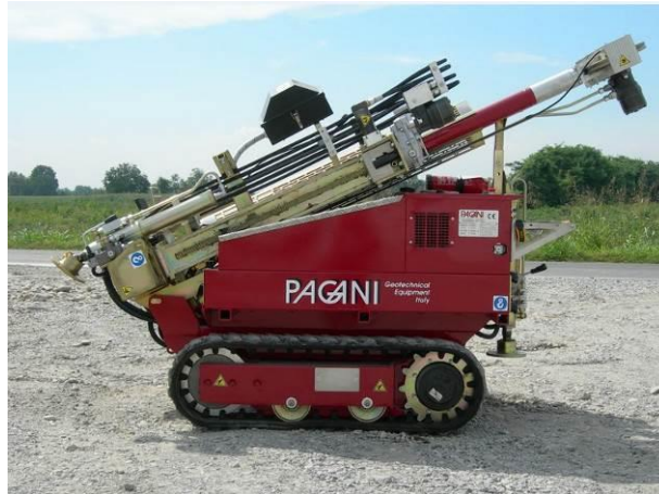
Slika 2: Dinamični penetrometer TG 63-100
